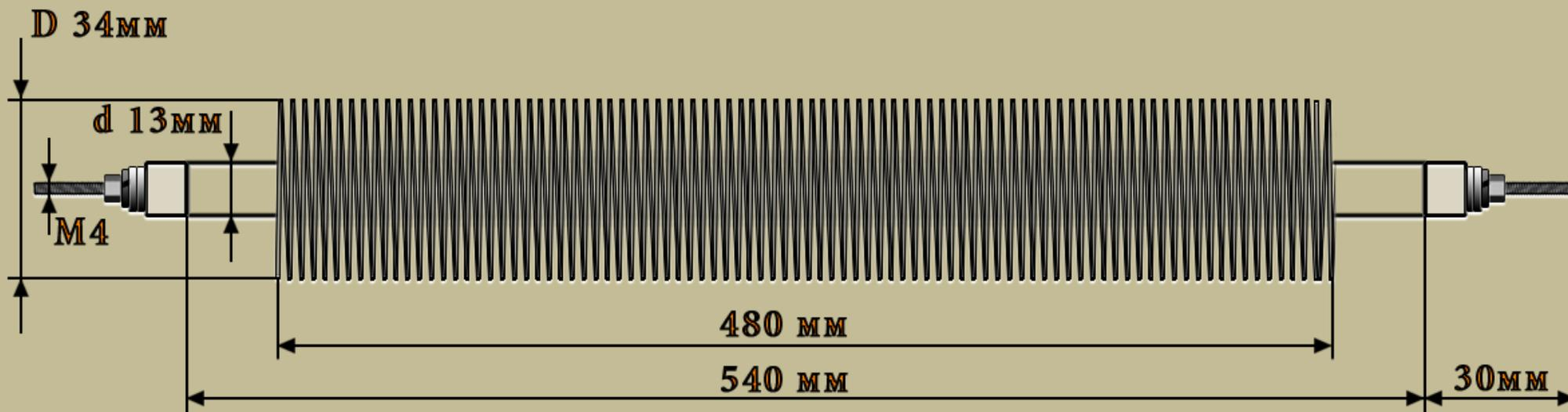
Принцип работы трубчатого ребренного нагревателя типа ТЭНР основан на выделении тепла при прохождении электрического тока через установленный в его корпусе нагревательный элемент высокого сопротивления. При подаче напряжения на тэн, нихромовая спираль сильно нагревается. Происходит преобразование электрической энергии в тепловую. Тепловая энергия от разогретой до высокой температуры спирали последовательно передается наполнителю и металлической оболочке тэна, затем алюминиевому ребрению.
