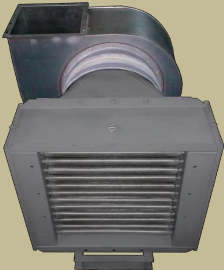
Электрокалориферные установки СФОЦ предназначены для работы с вентиляционной сетью. Во избежание выхода из строя электродвигателя вентилятора, аэродинамическое сопротивление сети должно соответствовать характеристике центробежного вентилятора.
